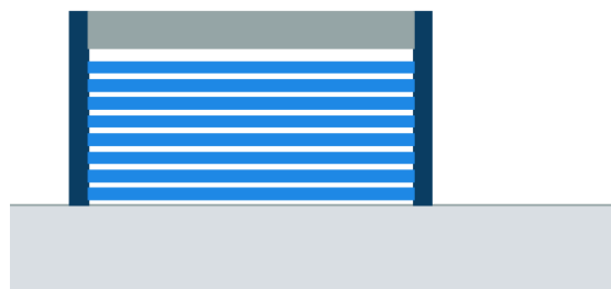
图 3.8 卷帘式密闭防洪门 结构示意图
