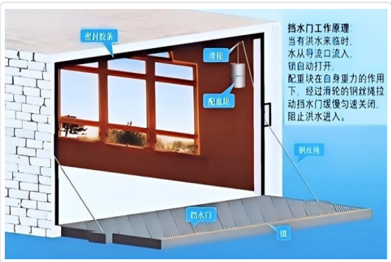
图 3.6 通道密闭防洪门（地埋式）结构示意图
